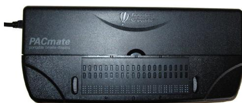
**Brajev displej** je uređaj koji čini plastično kućište na kome se nalaze dva reda tastera i Brajev red. Brajev displej prevodi tekst iz računara na Brajevo pismo, tako što se reči koje vidimo na ekranu pretvaraju u pokretne šestotacke Brajevog pisma na kućištu Brajevog displeja. Pored toga, tasteri se mogu isprogramirati tako da obavljaju unapred definisanu radnju (npr. pritiskom na određeni taster otvara se definisani folder, fajl).
