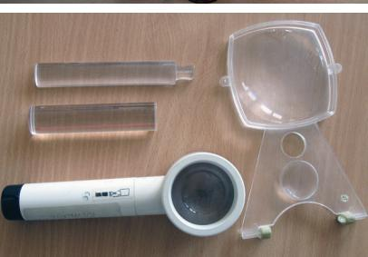
Postoje različite vrste lupa koje se koriste u skladu sa individualnim potrebama učenika. **Klasične lufe** su uveličavajuća stakla i kao takva su najjednostavniji optički instrument. Postavljaju se između oka posmatrača i predmeta posmatranja. Pristupačne su i **ručne lufe sa sijalicom** koje omogućavaju fokusirano osvetljavanje predmeta posmatranja. **Lupa koja visi oko vrata** omogućava slobodu pokreta ruku...
