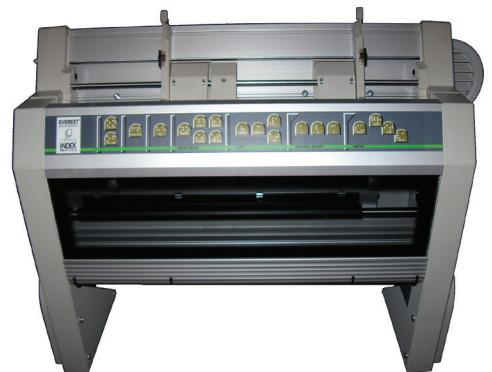
**Brajev štampač** je štampač sa mehaničkom iglom koji na papiru adekvatnog formata i debeline ispisuje tekst na Brajevom pismu.
